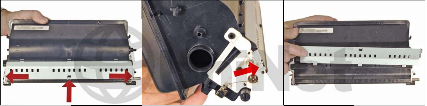
27. Remove the bottom metal plate.
