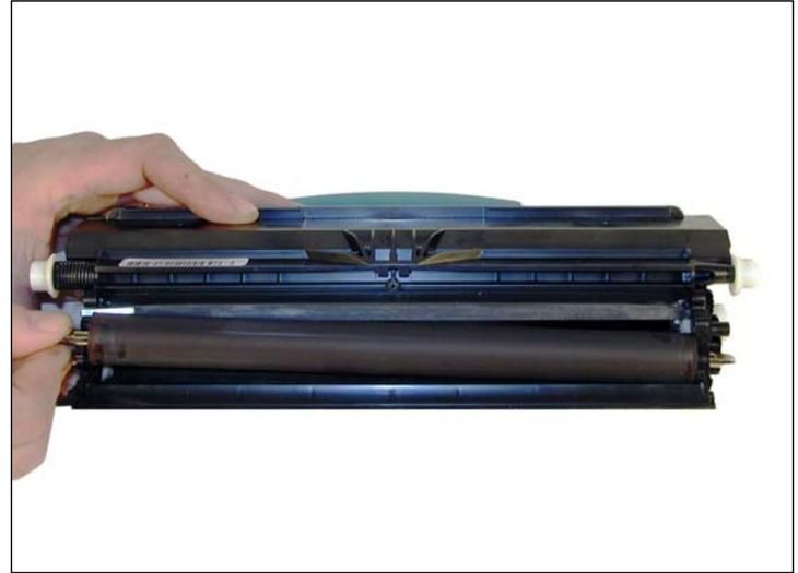
9. Limpie el rodillo revelador con un paño de algodón libre de pelusa y reinstale el rodillo. En este punto no es recomendable usar productos químicos para limpiar este rodillo. Instalar el rodillo con el eje chanfleado del lado de engranajes.
