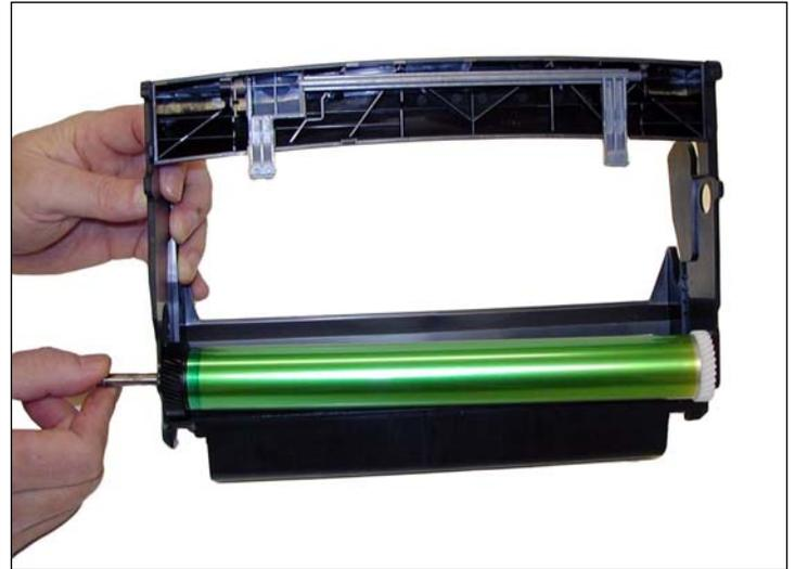
2. Retirar el eje por la otra punta, lado engranaje mayor. Si trata de retirarlo al revés puede trabarse con el contacto de descarga a tierra dentro del OPC y dañarlo.
