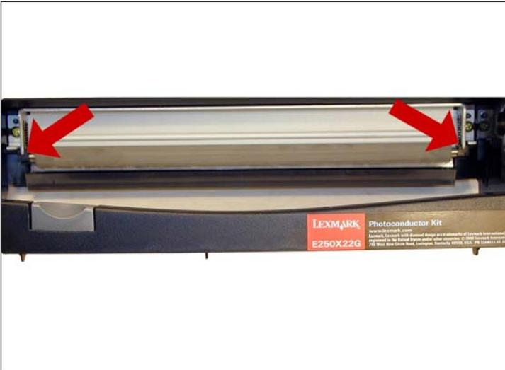
9. Instalar el PCR y sus soportes.
