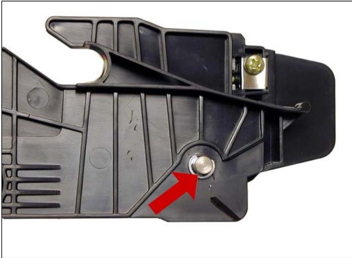
1. Extraer la arandela de seguridad del eje del fotorreceptor, lado engranaje pequeño.
