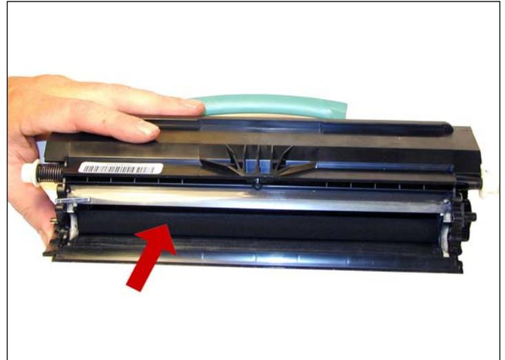
7. Remueva el rodillo revelador. Limpiar el rodillo alimentador de toner situado dentro de la tolva con aire comprimido si disponible o con aspirador de toner. Limpiar la Dr. Blade con un paño de algodón y alcohol isopropilico.
