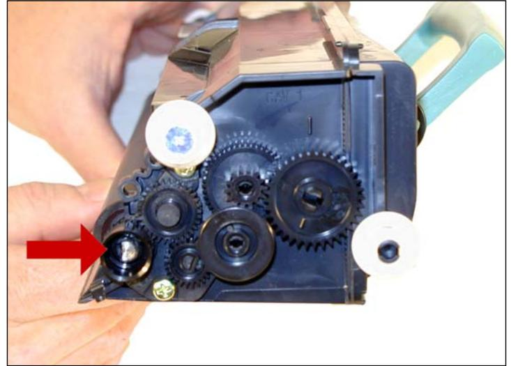
4. Del lado de los engranajes del cartucho, remueva el engranaje de impulsión del Rodillo Revelador. Puede que necesite un destornillador pequeño para sacar el engranaje.
