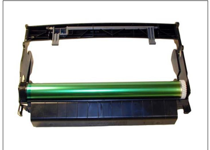
10. Con la tolva de desperdicios mirando hacia Ud, instalar el OPC de tal manera que el engranaje mayor quede a su izquierda y el resorte del engranaje menor hacia abajo.
