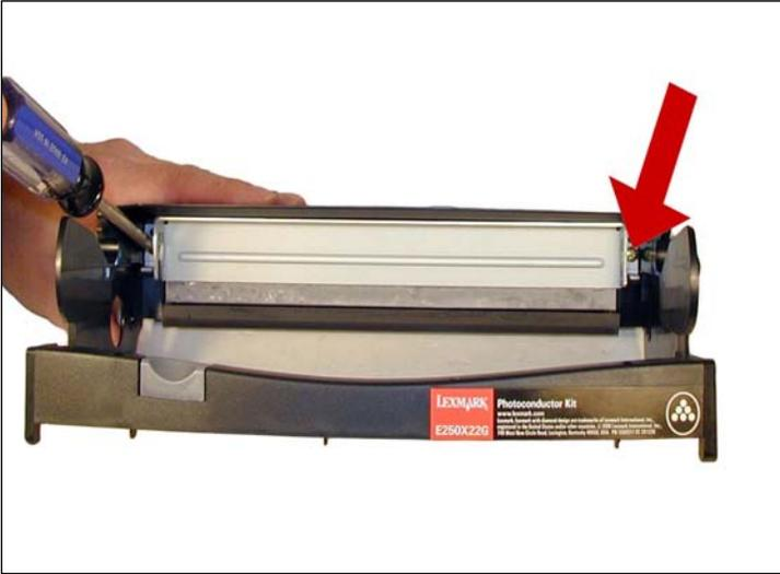
7. Instalar la nueva cuchilla recubierta con polvo lubricante apretando los dos tornillos.
