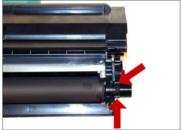
11. Instale todos los engranajes. Asegurese que el impulsor del rodillo intercala bien con el engranaje de acople y estén plenamente asentados.
