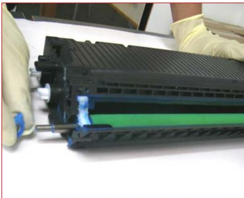
28. **\*REMOVING THE SUPPLY ROLLER.**
