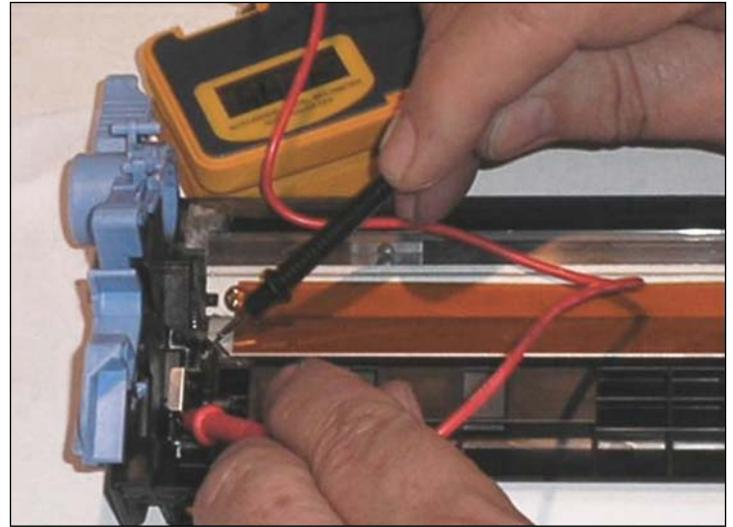
**TESTING THE WIPER BLADE CONTACT**
