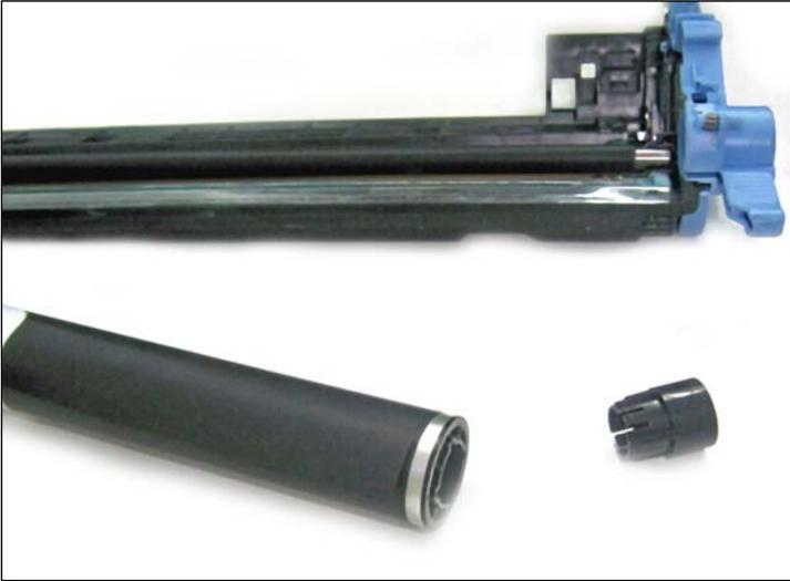
**INSTALLING THE NEW OPC DRUM**
