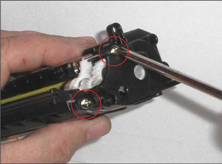
**REMOVING THE GEAR-SIDE END PLATE**
