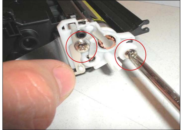
**REMOVING THE CONTACT PLATE**
