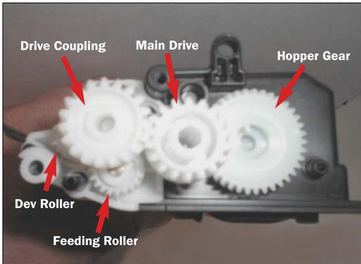
**POSITIONING THE GEARS**
