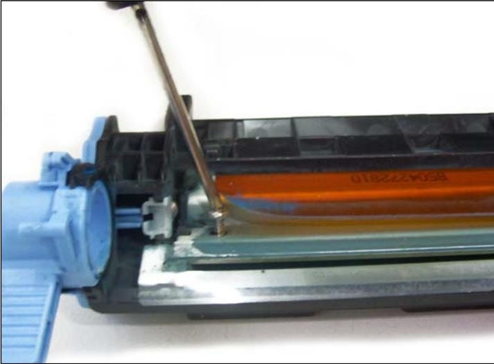
**DISASSEMBLING THE WIPER BLADE**
