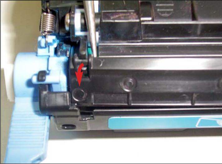
**RELEASING THE DRUM SHUTTER FROM THE HOPPER**
