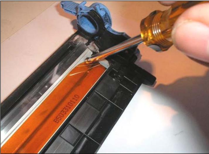
**ASSEMBLING THE WIPER BLADE**
