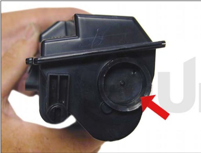
1. Remove the fill plug.
