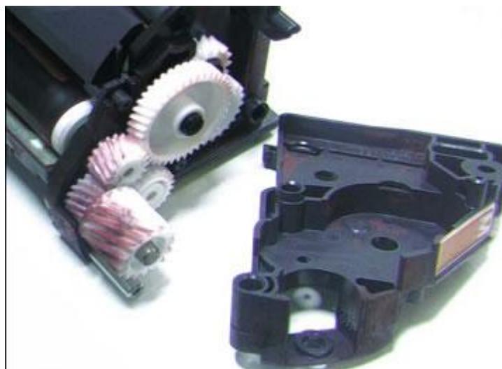
4) Отсоединяем боковую крышку
