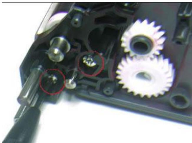
5) Отсоединяем четыре шестеренки и убираем их в сторону.
