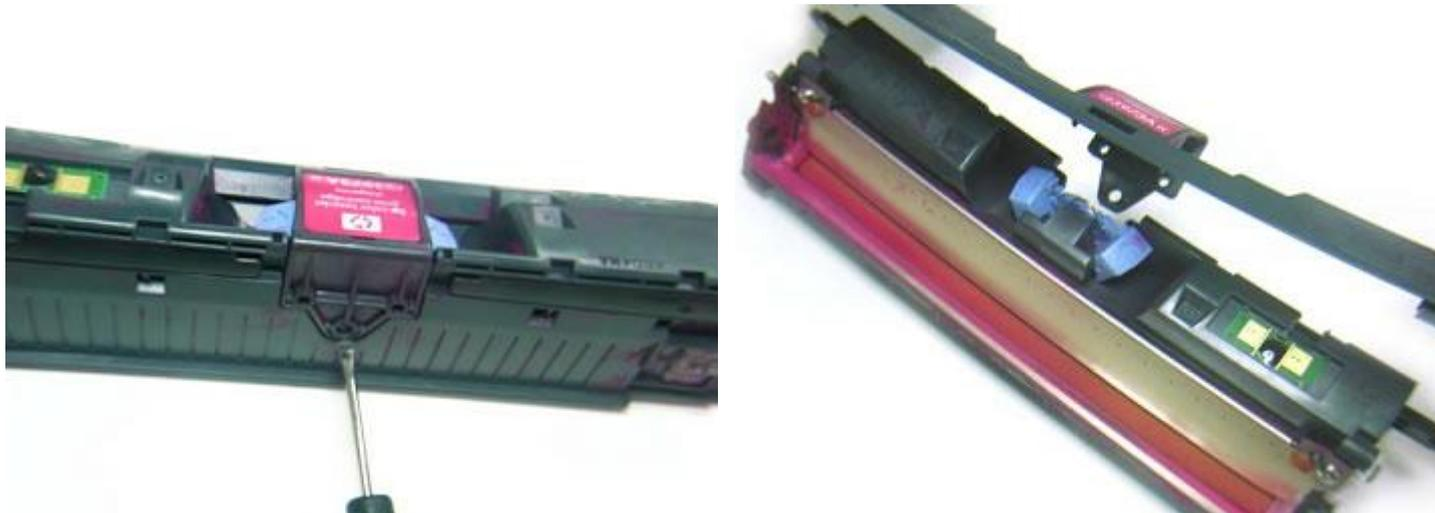
11) Теперь нам необходимо снять дозирующее лезвие, но чтобы до него добраться нам необходимо снять декоративную деталь которая закрывает к нему доступ. Для этого подцепляем плоской отверткой за край и извлекаем деталь.
