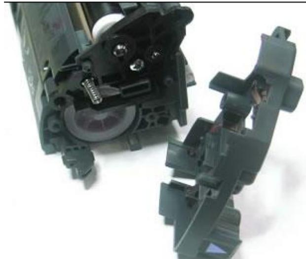
2) Отсоединяем боковую крышку
