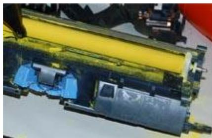
16) Засыпаем тонер в щель которая образовалась после удаления дозирующего лезвия.
