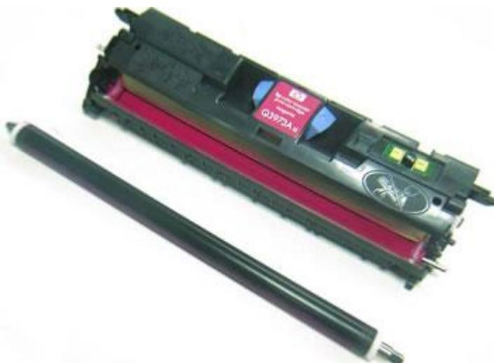
9) Отсоединяем деталь которая фиксирует ролик проявки картриджа.
