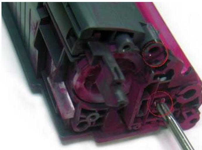
7) Отсоединяем деталь которая фиксирует ролик проявки картриджа.
