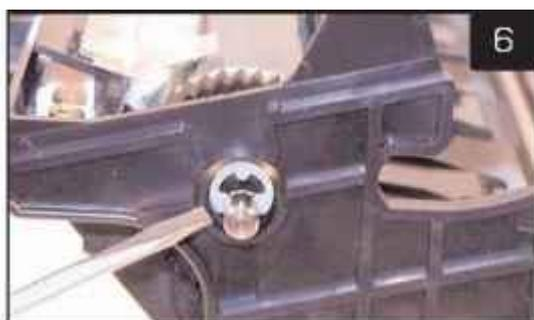
7. Выньте ось барабана с неприводной стороны. Если делать это с приводной стороны, ось зацепит заземляющий контакт и повредит его
