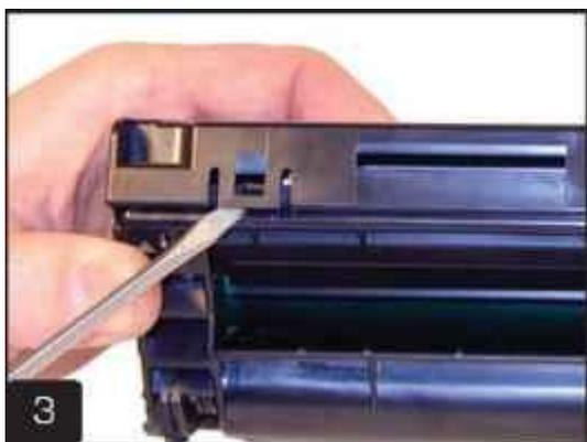
4. Аккуратно снимите крышку. Для этого может понадобиться зафиксировать защелки
