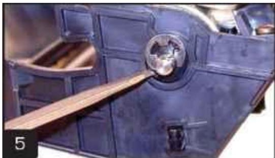
6. Снимите Ш-образное кольцо с противоположной стороны оси
