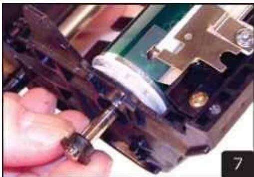
8. Аккуратно извлеките барабан. Помните, что на приводной стороне находятся две шестерни: одна из них зафиксирована, другая - нет. На противоположной стороне находятся втулка и пружина. Не потеряйте эти детали
